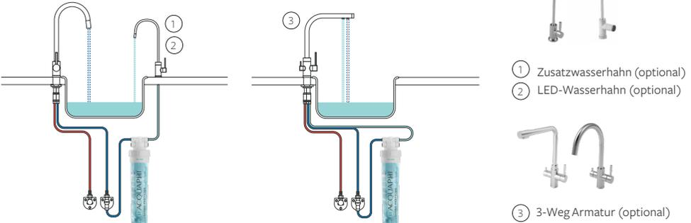
Patrone am Ende der angegebenen Autonomie wechseln, oder falls die erreichte Durchflussleistung geringer wird. Patrone ist innerhalb von 365 Tagen nach dem Einbau (vertikale Installation) zu wechseln! Für die Erstinstallation sind sämtliche Bauteile, Schläuche, einschliesslich Kleinteile, vorhanden.
