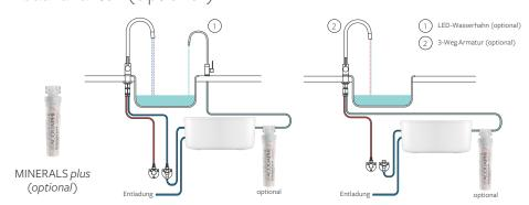
Die Patronen müssen innerhalb von 365 Tagen nach dem Einbau gewechselt werden. Für die Erstinstallation sind sämtliche Bauteile, Schläuche, einschliesslich Kleinteile, vorhanden.
