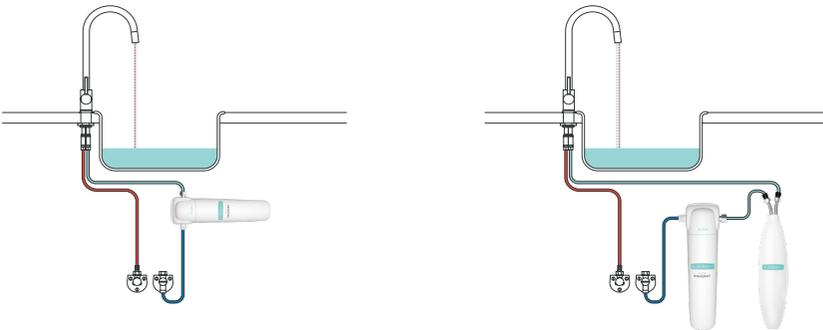
UNIVERSO lässt sich leicht unter jeder Spüle an der Zuleitung fürs Kaltwasser montieren und benötigt keine Änderung des bestehenden Wasserhahns. Eine LED signalisiert das Erreichen der Autonomie (Wechsel von blau auf rot). Sicherheitshalber ist die Patrone innerhalb von 365 Tagen nach dem Einbau zu wechseln!
